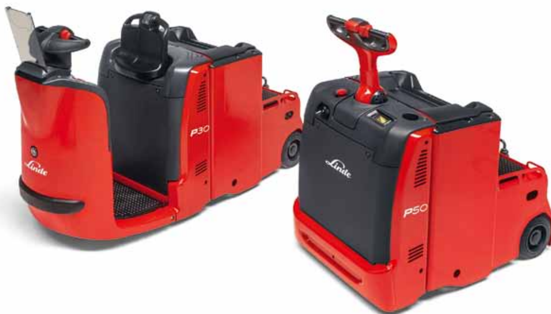
Fahrerstandsschlepper P30 mit optimaler Rundumsicht und das Mitgängerfahrzeug P50 für das Arbeiten in extrem beengten Platzverhältnissen.
