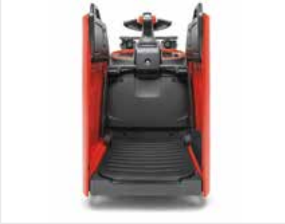
Stahl-Chassis schützt den Bediener
