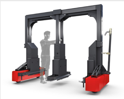
Entgegen der Fahrtrichtung verschiebbarer Mittelsteg beim LT BM
