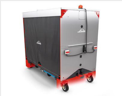
Optionales Sicherheitspaket: Wetterschutz, gefederte SE-Bereifung, Rundumleuchte und Heckbeleuchtung
