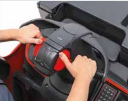
Ergonomischer höhenverstellbarer Lenker
