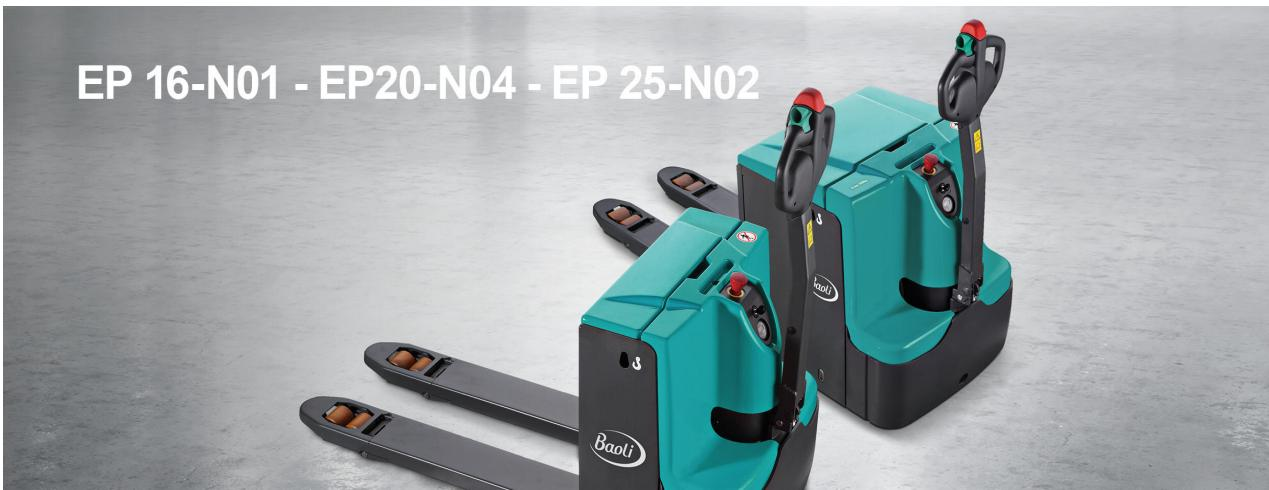
Die Niederhubwagen EP 16-N01, EP 20-N04 und EP 25-N02 mit Tragfähigkeiten von 1.600, 2.000 bzw. 2.500 kg sind ideal für das Be- und Entladen von Fahrzeugen und für alle Arten von Handhabungsarbeiten mit mittlerer Intensität. Hohe Verarbeitungsqualität und herausragende technologische Lösungen machen diese Niederhubwagen zu einem echten Maßstab in ihrem Produktsegment. EP 16-N01, EP 20-N04 und EP 25-N02 garantieren maximale Effizienz und verringerte Wartungskosten.
